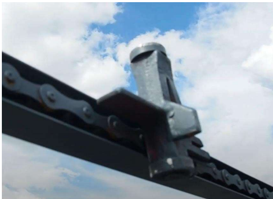
Foto 3. Prendedor de vinha de maquina acoplado à corrente de alimentação
