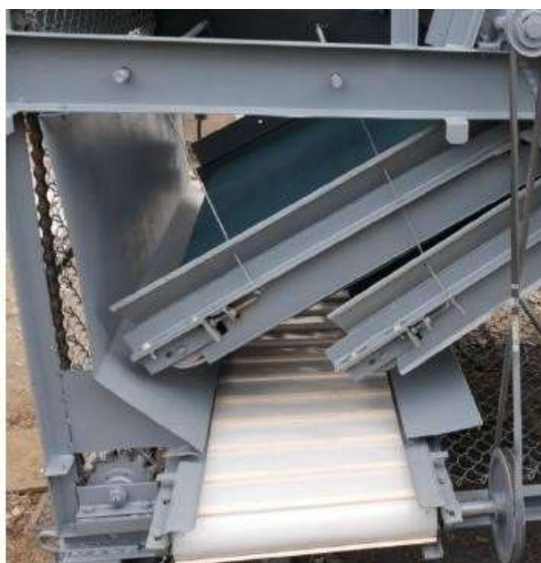
Foto 11. Correia transportadora final encaminhando cones limpos para fora da maquina
