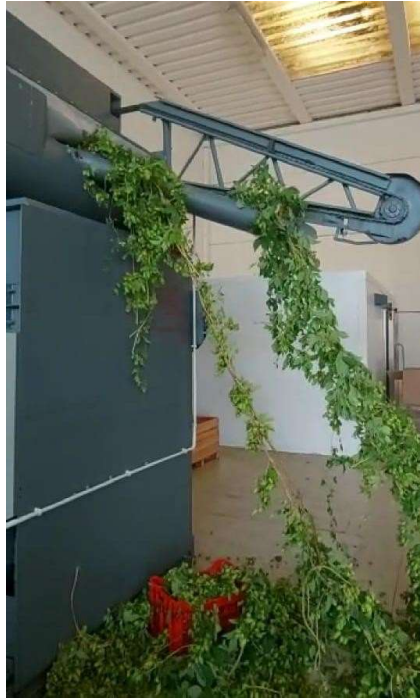
Foto 1. Detalhe no local que as vinhas são encaixadas à corrente de alimentação
